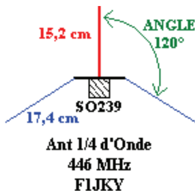
Schéma antenne 446MHz
